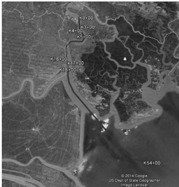
Hình 1. Tuyến luồng Soài Rạp và vị trí khu vực bồi lắng bất thường (Km3-5 và Km 17)
